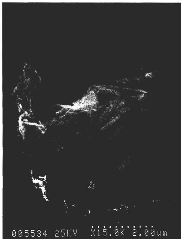
**Figura 11.** Micrografía en la región intercrítica de la ZAT, mostrando lajas de ferrita dislocadas.
