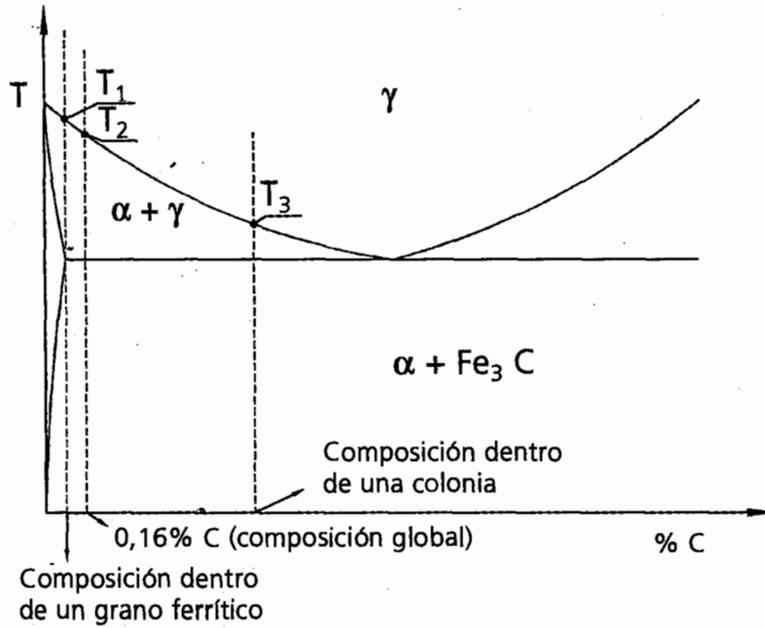
**Figura 7.** Diagrama Fe-C. Transformación eutectoide
