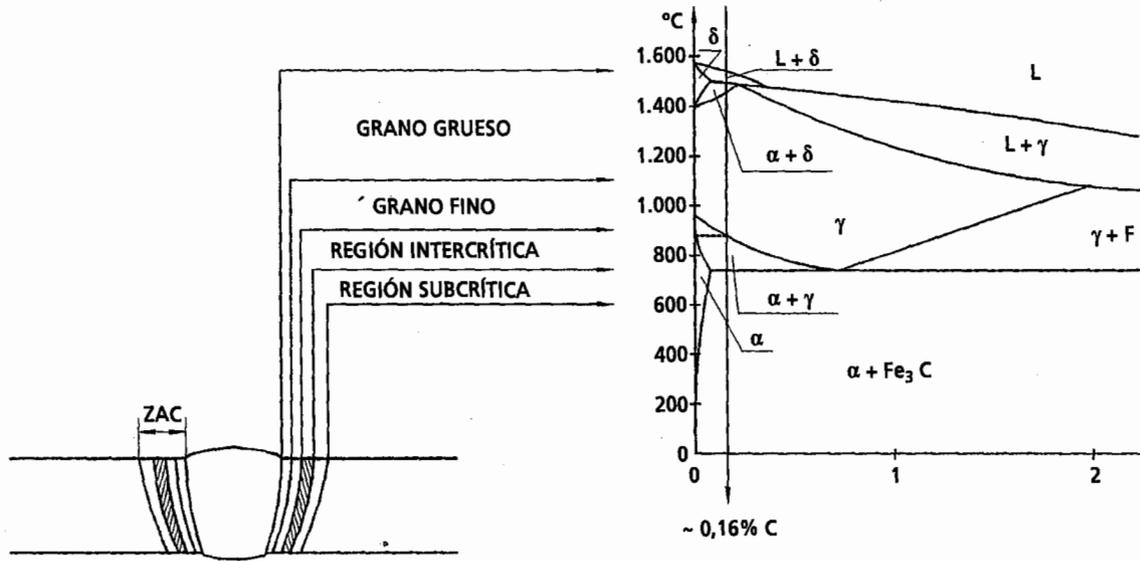
**Figura 1.** Esquema de las distintas regiones en la ZATy diagrama de fases correspondiente, para un acero con 0,16 % de carbono.
