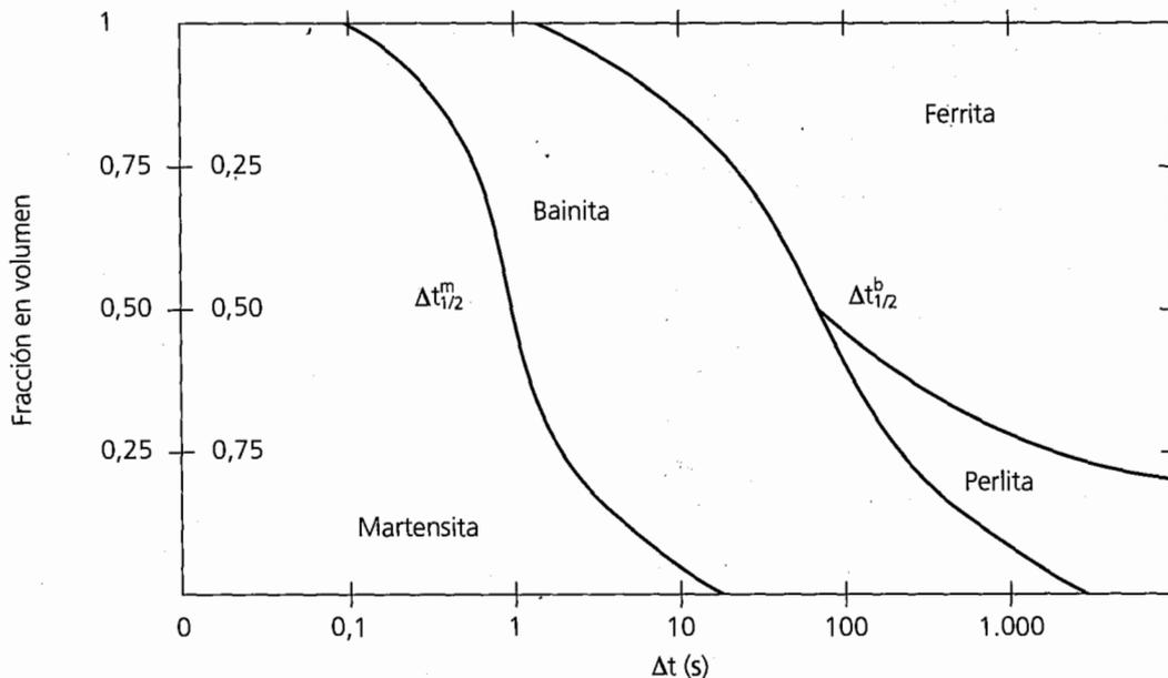
**Figura 15.** Diagrama Dt(s), mostrando la variación de la fracción en volumen de la microestructura, con la velocidad de enfriamiento. M.Inagaki y H. Sekiguchi. Inst. Metals Japan 1960.
