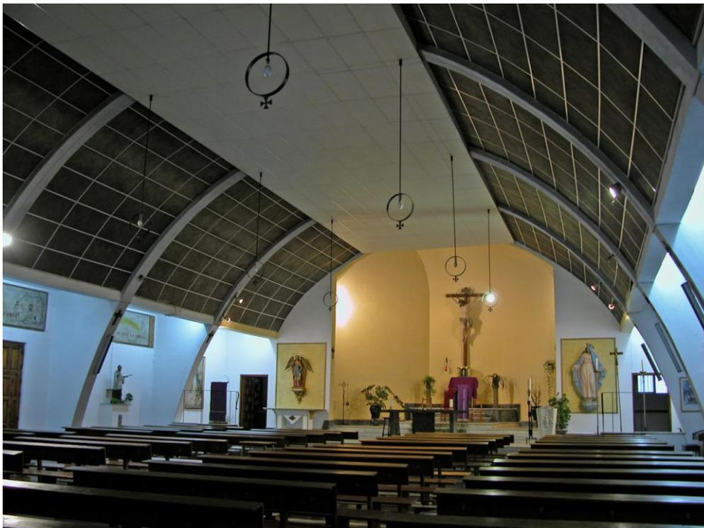
El interior, de una gran austeridad, es de una sola nave construida en estilo fabril de aspecto aeronáutico. Una gran bóveda de arcos parabólicos nos conducen hacia el espacio poligonal del presbiterio. Los espacios entre los pórticos estructurales se han aprovechado para construir sencillas capillas.
