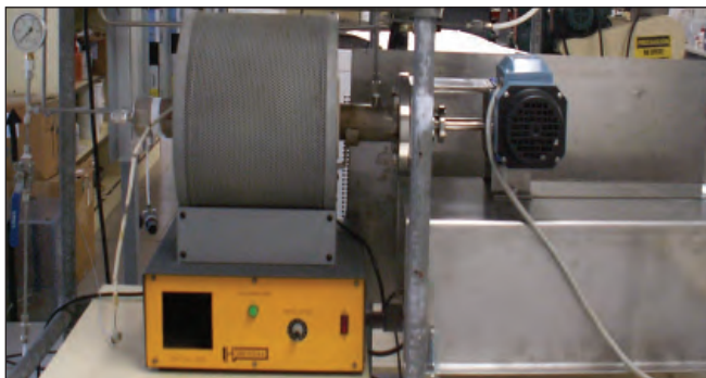
Fig. 1: Reactor con lecho rotativo y control de temperatura y atmósfera
