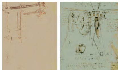
Fig. 1: Máquinas grúa de Filippo Brunelleschi, recogidas en la colección publicada por Bonaccorso Ghiberti en 1420.
