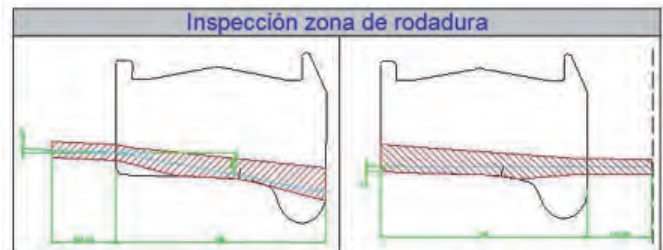
Fig. 13: Inspección Zona Rodadura
