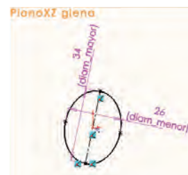
Fig. 12: Parametrización de los diámetros de la glena
