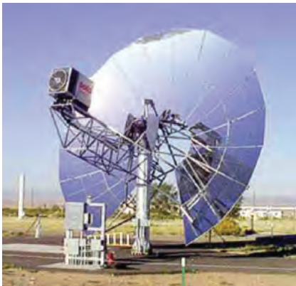
GENERADOR SOLAR CON MOTOR STIRLING
