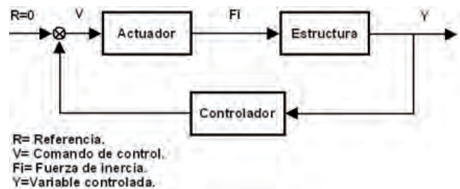
Fig. 10: Esquema de la ley de control del amortiguador de masa activo
