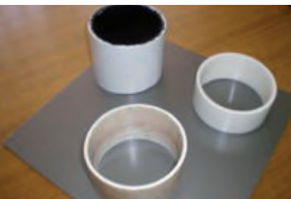
Prototipos de tubos fabricados con materiales microcelulares con base de plástico. • Foto: DICYT.
