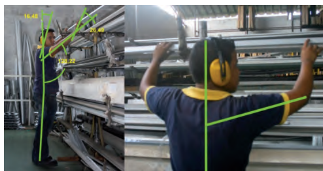
Fig. 7: Medición de ángulos diagnóstico almacenamiento – puesto almacén de perfiles.
