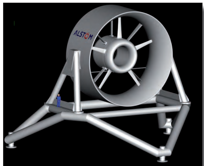
Vista infográfica de la turbina mareomotriz en construcción
