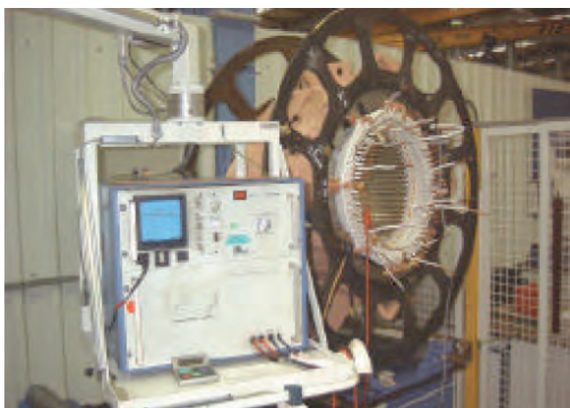
Figura 3: Ensayo de ondas de choque y formas de onda de una bobina en cortocircuito y una bobina normal, inducidas en el ensayo de ondas de choque
