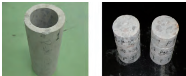
Fig. 3: Muestras obtenidas a partir de la extracción y corte de testigos
