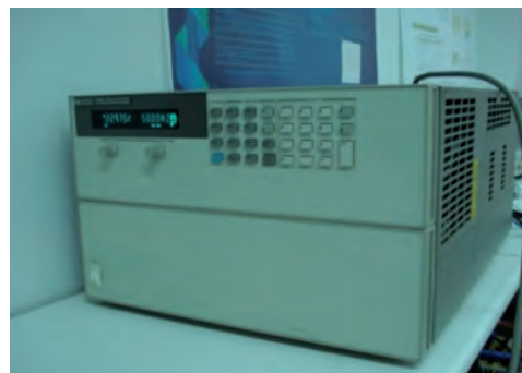
Fig. 3: Fuente de perturbaciones programable como sistema generador.
