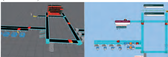
Figura 4: Modelo de Simulación de Eventos Discretos en 3D y 2D
