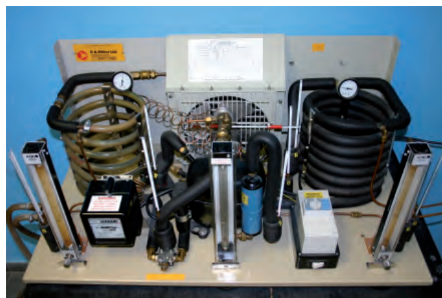
Figura 2: Bomba de calor instrumentada utilizada en la práctica.
