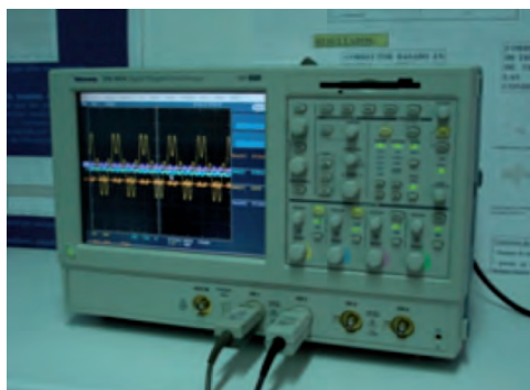
Fig. 5: Osciloscopio para ver formas de onda.
