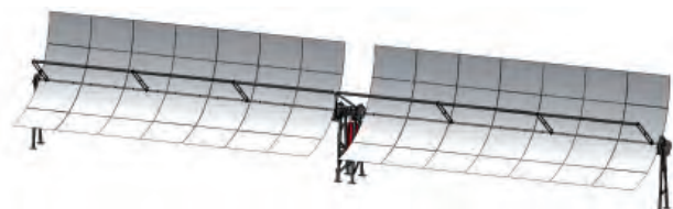
Fig. 4: Tramo central de un SCA con torre de accionamiento
