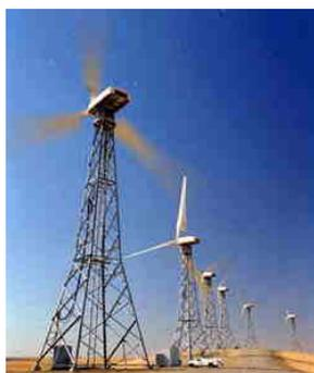
Figura 13.1.- Aerogenerador con torre de celosía
