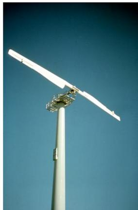
Figura 9.3.- Aerogenerador bipala
