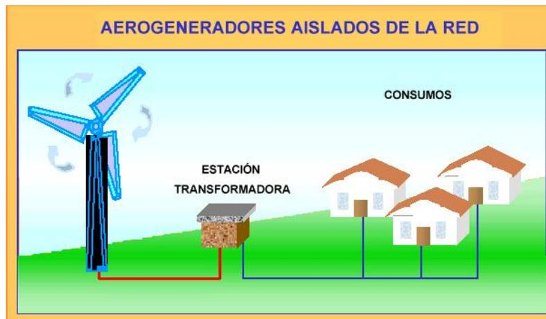
Figura 25.1.- Aerogeneradores aislados de la red
