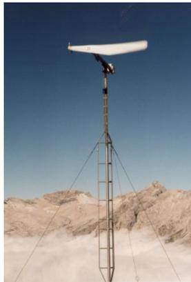
Figura 9.4.- Aerogenerador monopala
