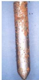
Elemento metálico con el uso del gasóleo normal
