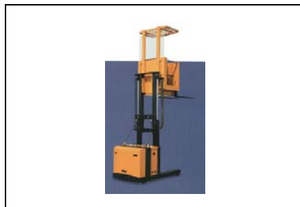
Figura 3.16. Recogepedidos de alto nivel
