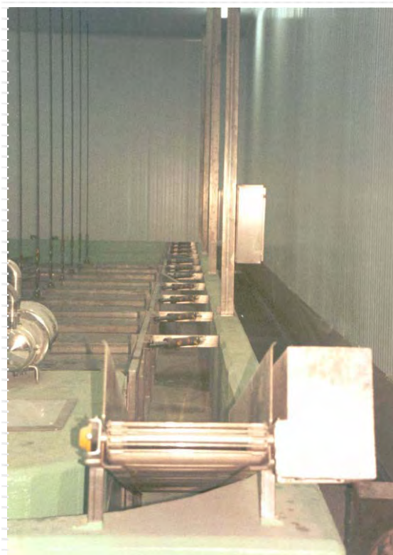
Foto 1.5.8-7: En esta fotografía se puede observar la cinta transportadora que lleva a los quesos al canal de entrada, así como las compuertas que desvían los quesos y permiten su entrada en los diferentes niveles de los cestones de salado.
