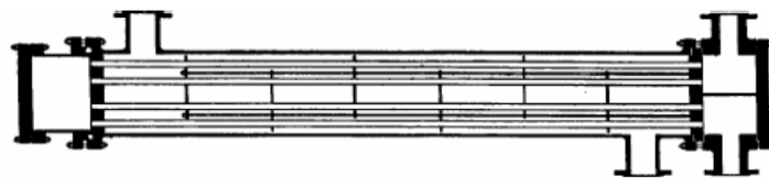
FIG. 7.15. Intercambiador 1-2 de cabeza flotante empacada. (Patterson Foundry & Machine Co.)
