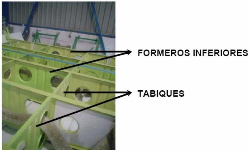
En la zona de puertas se montan la puerta del avión, tanto la derecha como la izquierda, y tres ventanas del mismo. En esta grada se unen los formeros laterales mediante larguerillos y se cubren con el revestimiento. Para saber la localización exacta de las puertas y de las ventanas se usan útiles que simulan dichos elementos realizándose el montaje siguiendo la posición que indican.
