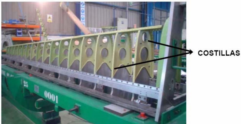
Cuando el borde de ataque está listo, se retira del útil y se conduce hacia el cajón de torsión terminado para proceder a su montaje. Finalizadas todas las operaciones de fuera de grada, el elemento esta preparado para su envío al cliente.
