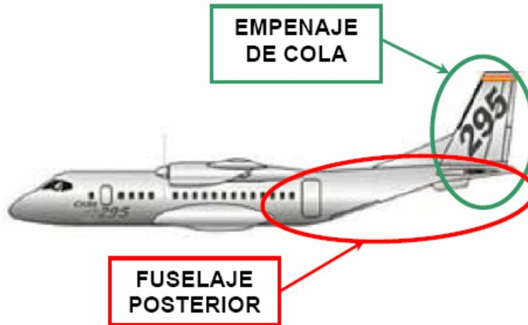
El fuselaje es la zona central del avión. Es la estructura que mantiene y porta en posición las alas, el empenaje y el motor. Entonces, el fuselaje posterior es la zona del avión que comprende la parte final del fuselaje hasta la cola del avión, portando el empenaje. Para mas claridad se muestra una imagen:
