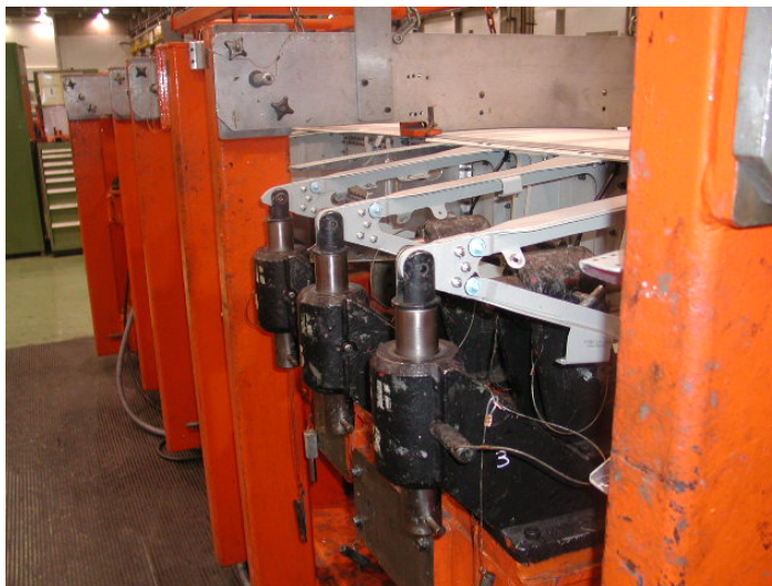
DETALLE SOPORTES DE HERRAJES DE GIRO EN GRADA DE LA FASE II. DISEÑO POCO ERGONÓMICO
