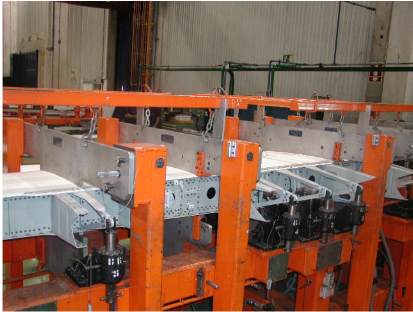
DETALLE SITUACIÓN DEL CONJUNTO DE CURVADORES EN LA GRADA DE LA FASE II
