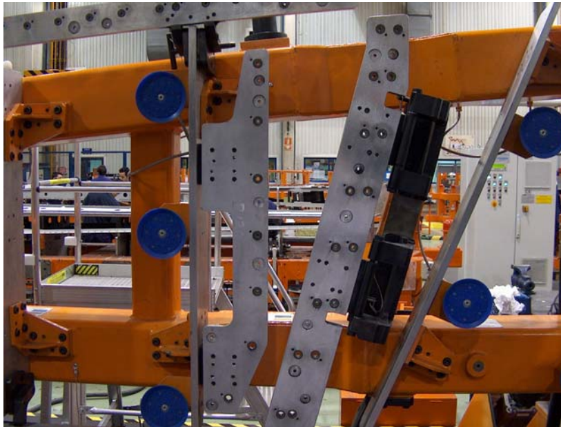
DETALLE SITUACIÓN DEL ÚTIL DE TALADRADO DE CARENA KARMAN EN GRADA FASE I. ESTE ÚTIL QUEDARÍA INTEGRADO EN LA NUEVA GRADA
