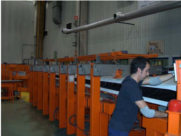
DETALLE GRADA FASE I CON DIFÍCIL ACCESO, ESCASA VISIBILIDAD Y TRABAJO EN HORIZONTAL
