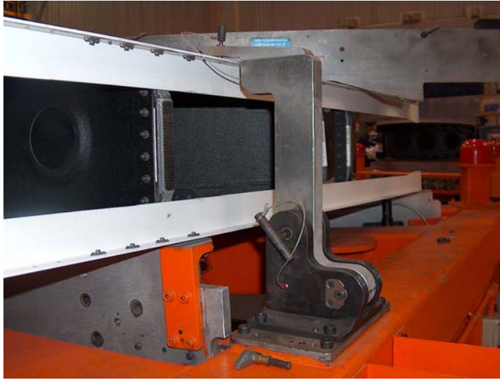
DETALLE TALADRO DE FIJACIÓN AL REVESTIMIENTO SUPERIOR DEL CAJÓN EN GRADA FASE II
