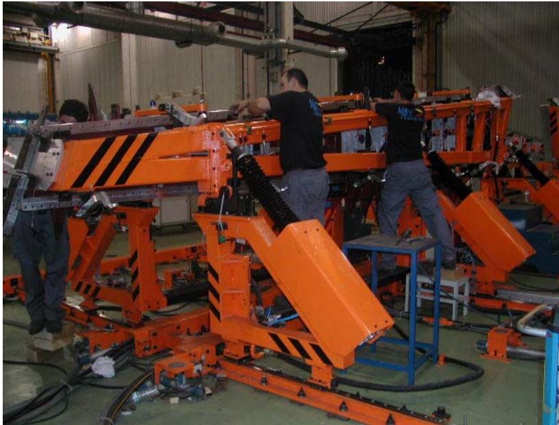
DETALLE MONTAJE DEL CALIBRE PATRÓN C/L A320 EN GRADA
