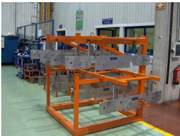
DETALLE DEL CONJUNTO DE CURVADORES. EXISTEN DOS JUEGOS DE AROX. 150 KG. C/U
