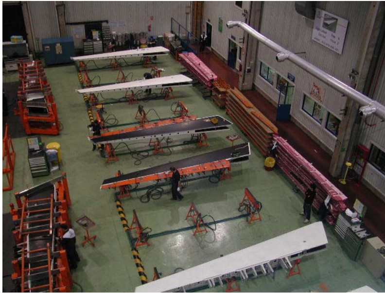
DETALLE LAY-OUT NAVE 2. EXISTEN DEMASIADAS OPERACIONES FUERA GRADA
