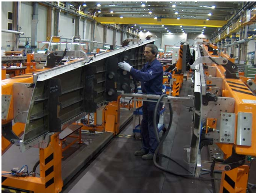
DETALLE GRADA FASE I CON FÁCIL ACCESO, VISIBILIDAD Y TRABAJOS EN VERTICAL
