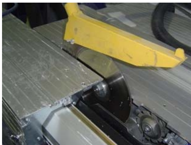
Figura 60: Recanteadora o máquina de mecanizado
