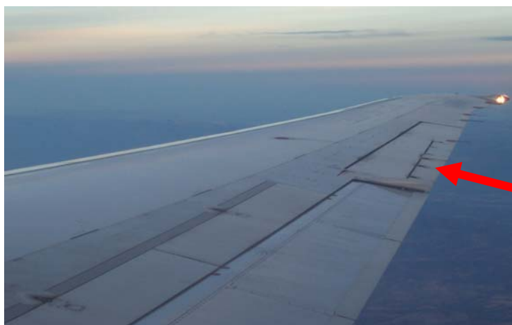
Figura 9: Alerón de dirección con compensador
