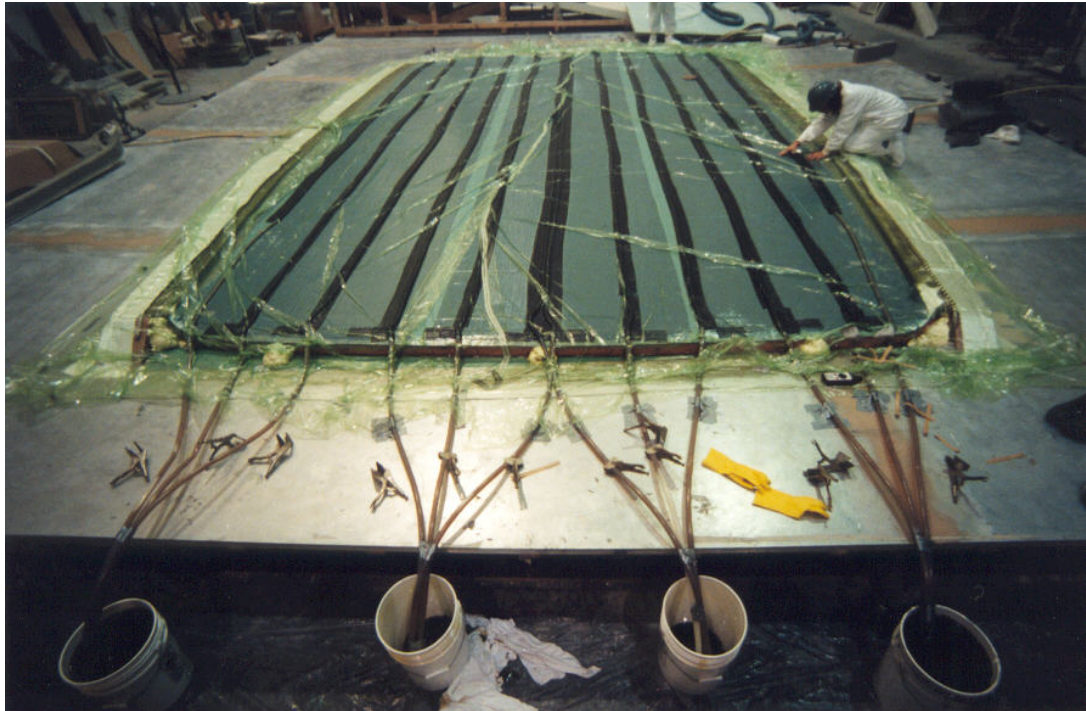
Figura 36: Imagen de un proceso RTM
