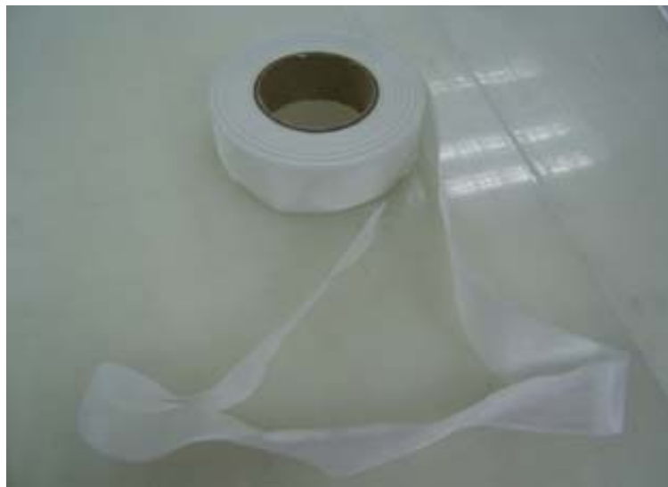
Figura 49: Cinta aireadora de fibra de vidrio
