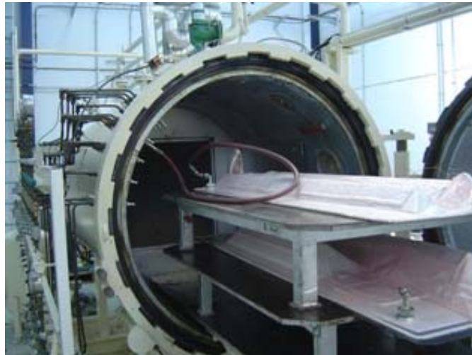
Figura 53: Introducción de elementos en autoclave
