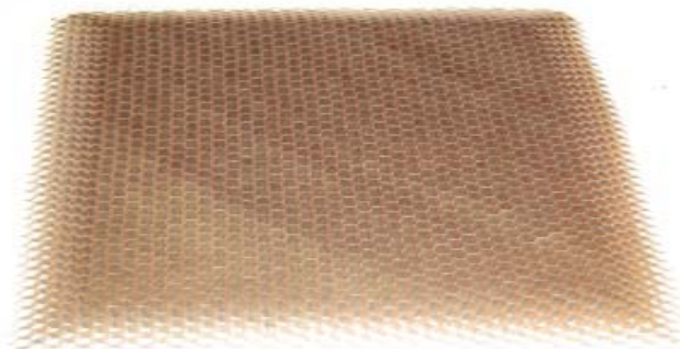
Figura 19: Probeta de núcleo honeycomb
