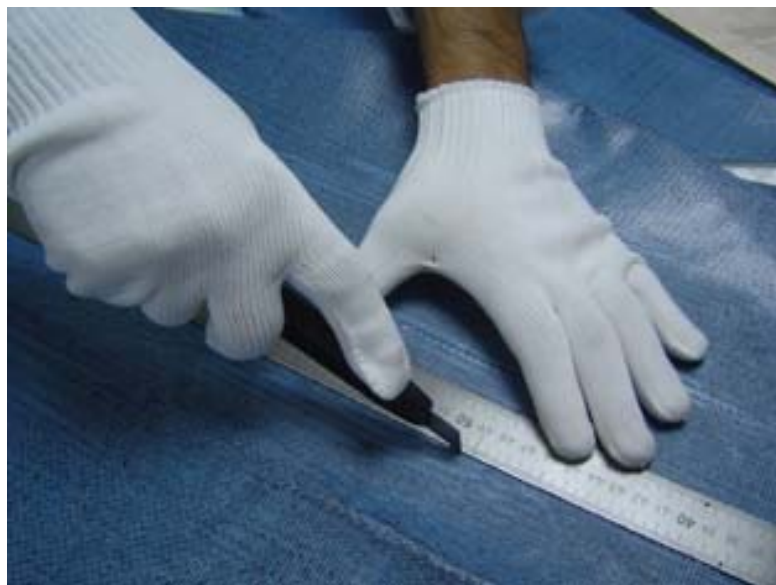
Figura 43: Corte Manual de telas
