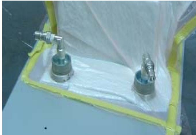
Figura 50: Pasta de sellado y tomas de vacío
