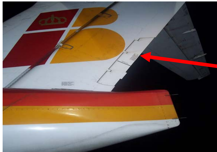
Figura 8: Timón de dirección con compensador
