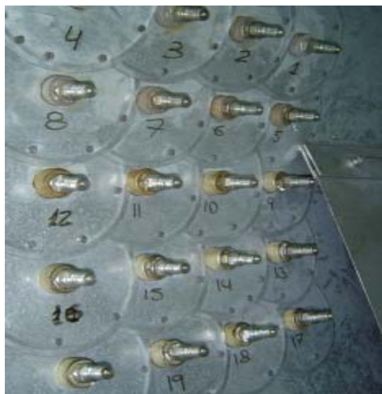
Figura 55: Tomas de vacío en autoclave
