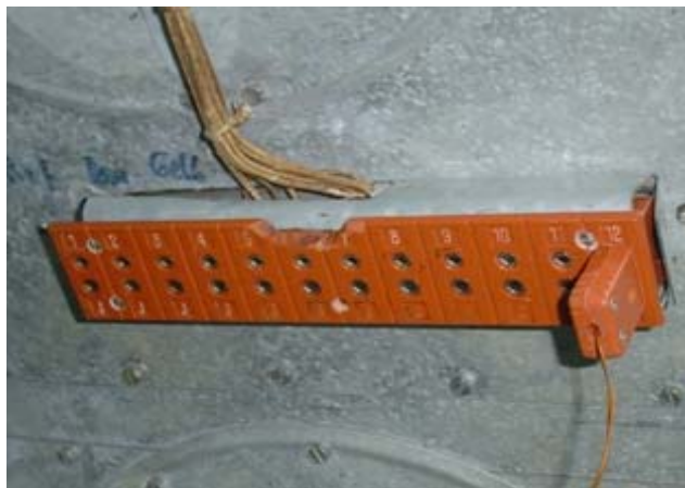
Figura 54: Tomas de termopares en autoclave
