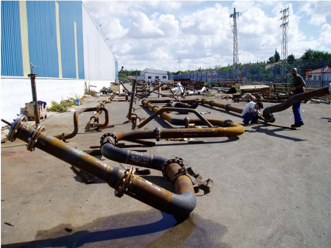
Fig. 8 Prueba hidráulica del servicio de alimentación de combustible. Cámara de maquinas del buque C/610 (astillero Naval Gijón)
