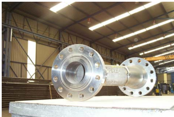
Fig 4 . Montaje de un spool de Piping Terrestre.
