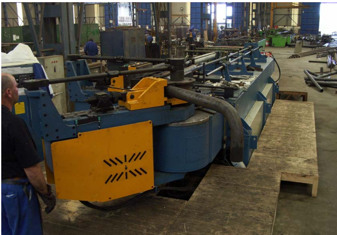
Fig.3 Curvado de Tubos
