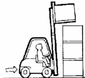
4. Con el freno de mano accionado y la palanca de dirección en punto muerto, incline el mástil hacia delante hasta la posición vertical.
