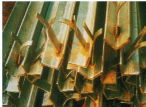
Fig. 6: Defectos en el recubrimiento galvanizado provocados por la escoria de soldadura no eliminada
