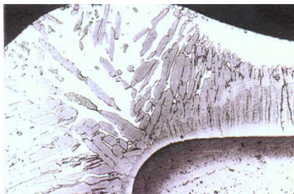
Fig 23: Recubrimiento galvanizado en el canto de una pieza;
