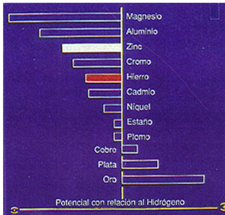
Fig. 19 Serie de potenciales electroquímicos (simplificada)
