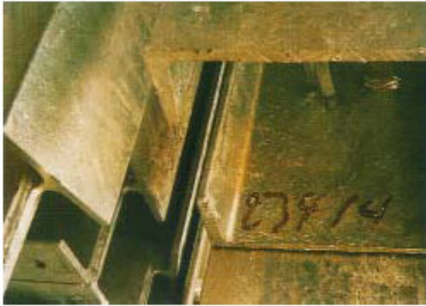
Fig. 7: Defecto por haber realizado marcas con pinturas que no se han eliminado previamente
