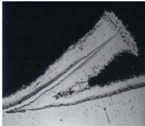
Fig.9: Sección transversal de un pico Formado por una estriación (x 2000)
