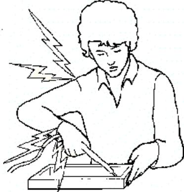
SI SE SUELDA HIERRO CON UN MANGO CURVO SE PUEDE BAJAR EL CODO Y MANTENER RECTA LA MUÑECA.
