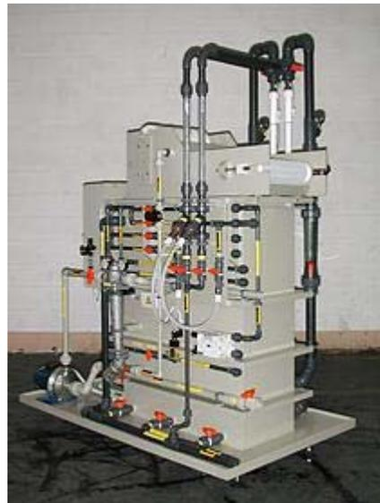
Posee dos filtros tubulares de membranas de características iguales a las indicadas anteriormente. El sistema se encuentra automatizado e incluye dos bombas: una de succión del reactor y que alimenta a las membranas y otra para la recirculación. Tiene una capacidad de filtrado de rango entre 50-100 l/h.
