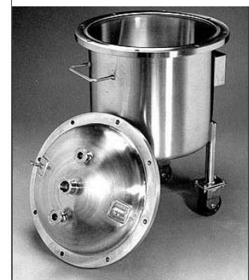
Figura 2.18: Ejemplo tanque mezclador (1)
