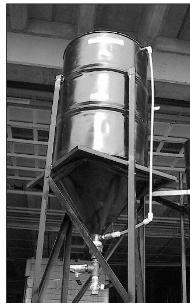
Figura 2.10 : Ejemplo tanque de pretratamiento
