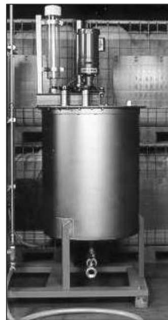
Figura 2.15: Ejemplo de tanque de lavado
