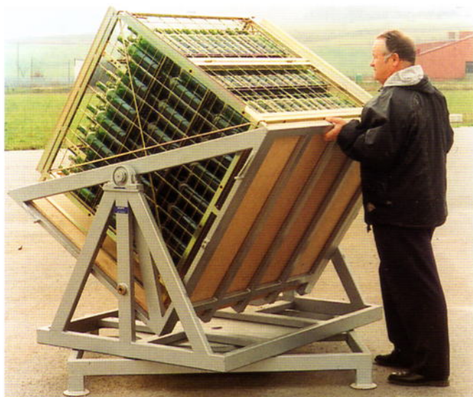
Detalle del sistema de volteo por medio de cojinete.
