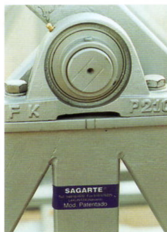
Detalle del sistema de volteo por medio de cojinete.
