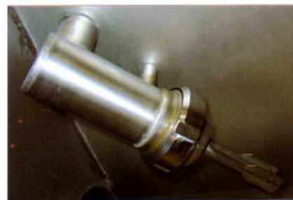
Sonda de detección de nivel.
