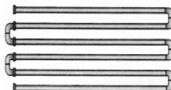
Figura 16.5: Tubo de mantenimiento en zig-zag
