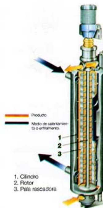
Figura 11.5: Intercambiador de calor de superficie rascada de tipo vertical
