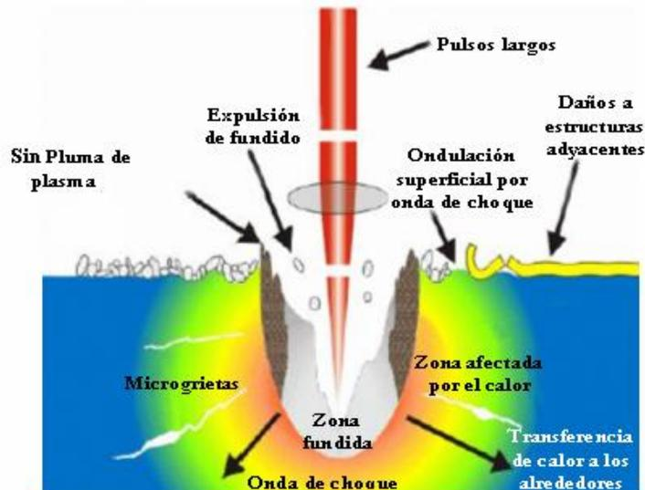
Figura 11. Efectos de corte o perforado mediante láser sobre el material. (Transmisión de Calor)
