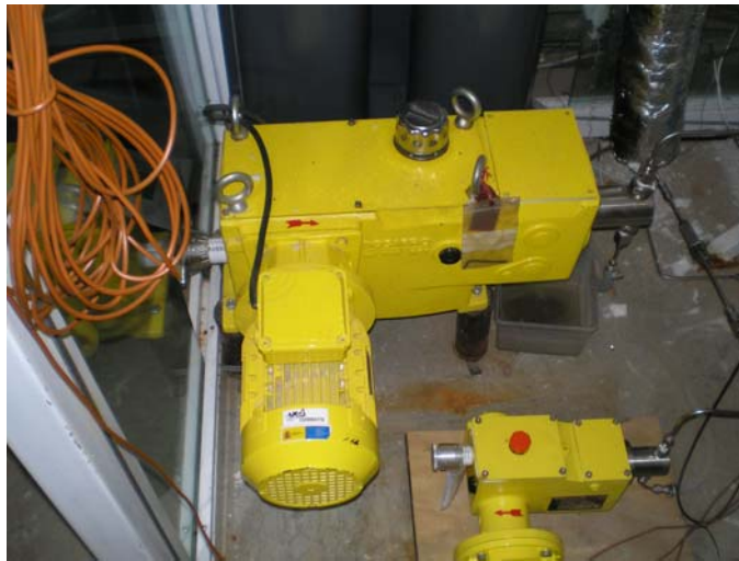
Figura 8: Fotografía de la bomba de alta presión
