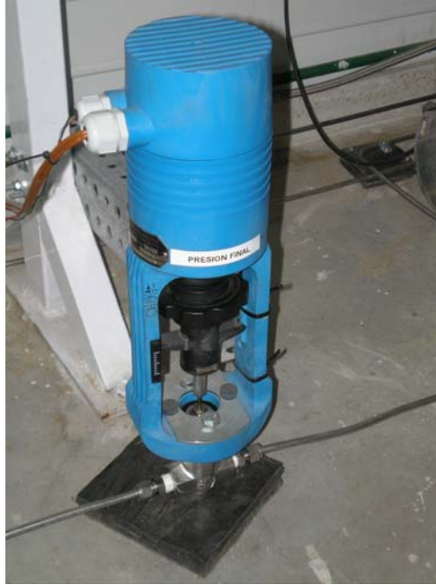
Figura 17: Fotografía de electroválvula reguladora de presión
