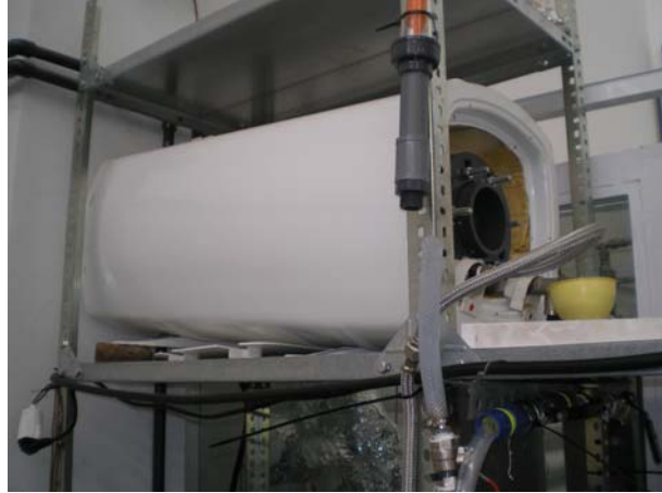
Figura 11: Fotografía del separador gas-líquido
