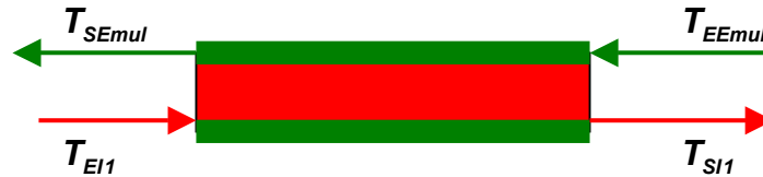
Figura 11. Esquema del intercambiador de calor para la corriente de residuo.
