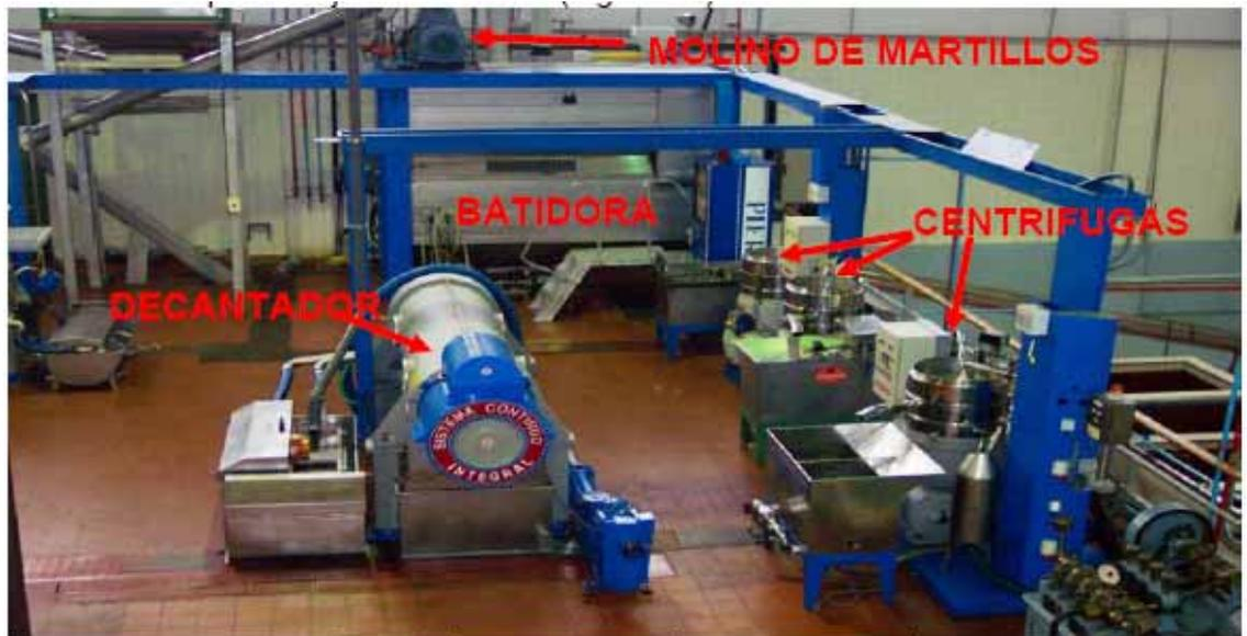
Figura .34. Planta continua de centrifugación para la extracción de aceite de oliva
