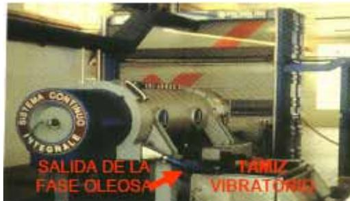
Fig.42.2. Decantador de dos fases
