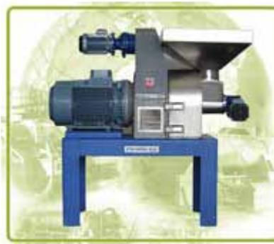
Fig.5. Molino Peralisi doble criba,HP50. Mod. Spagna.
