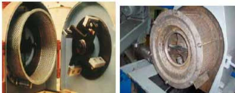
Figura.35. Interior de un molino de martillos
