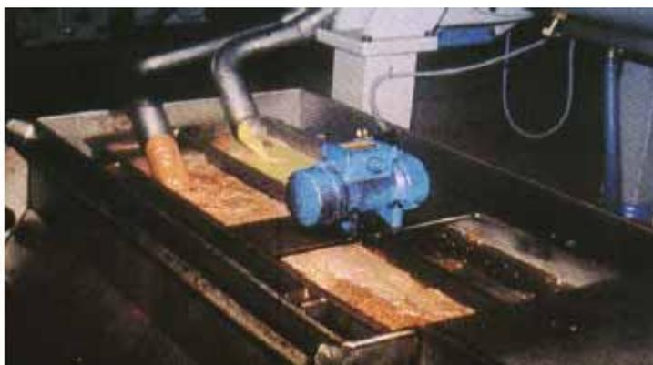
Fig.41. Tamiz vibratorio en la salida de los líquidos del decantador centrífugo.
