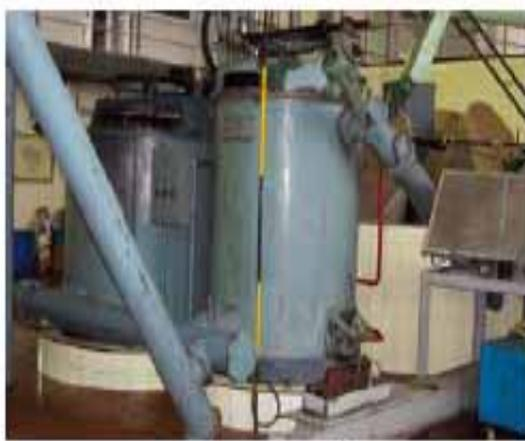
Fig.36. Batidoras cilíndricas verticales
