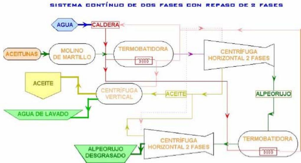
Fig.53. Esquema de sistema continuo de dos fases con repaso de dos fases.
