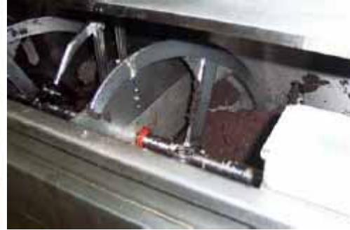
Fig.39. Interior de una batidora
