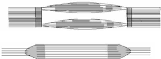
Según la disposición de los núcleos o de las capas de conductores del cable instalado hay que cortar aquellos y prolongarlos con latiguillos para facilitar su continuidad y formar el empalme.
