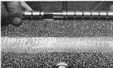
16 Colocar el clip de retención entre las dos cremalleras, terminando de juntar éstas, montándolas por encima del clip de retención.
