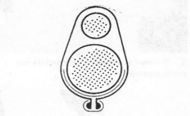
17 Importante: Para derivaciones múltiples, colocar la lámina de tal manera que, el solapa de adhesivo y los rieles de ésta, queden sobre la cubierta del cable mayor (ver figura).
