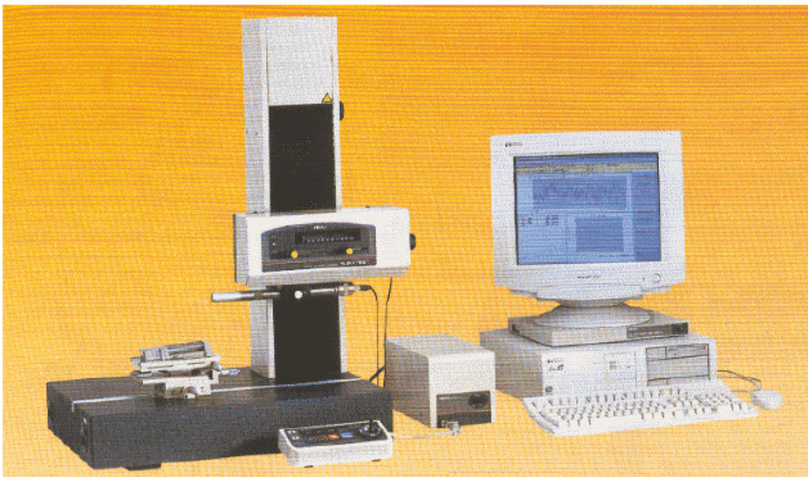
Vista de un rugosímetro actual operado mediante ordenador
