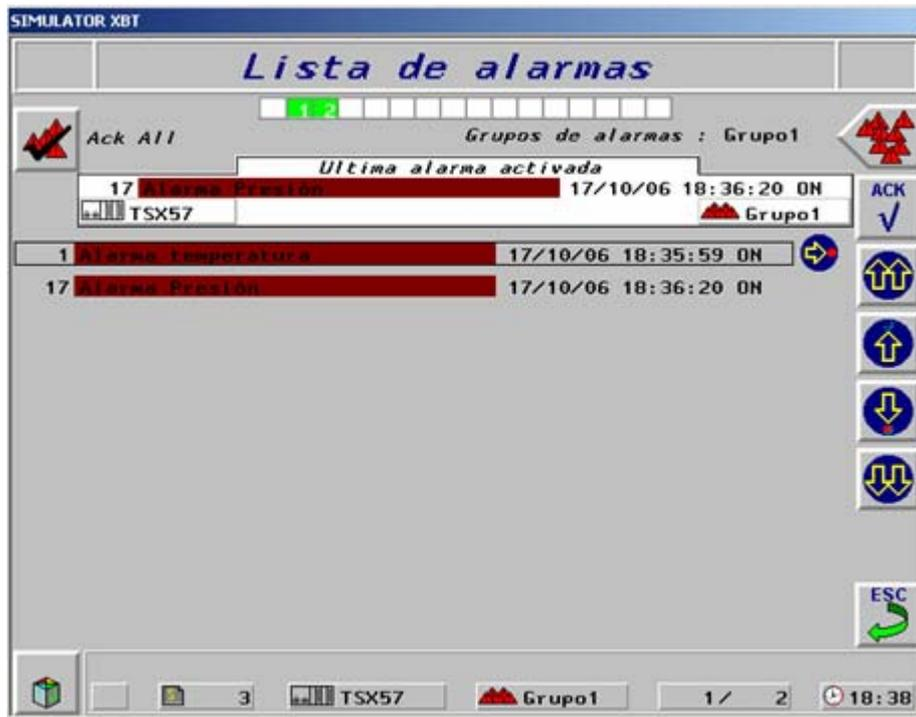
Figura 6-32. Pantalla de la lista de alarmas. En esta pantalla quedan reflejadas las ultimas alarmas que han saltado y si se han desactivado.
