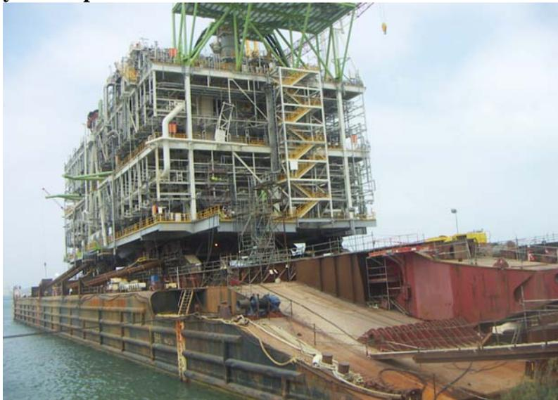
**Figura 14. foto de la plataforma instalada en la pontona**
