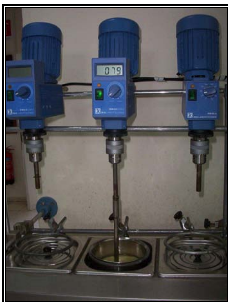
Fig. AII-3.2 Agitación a unas 80 r.p.m. durante la reacción de Neutralización
