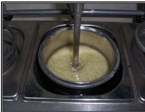
Fig. AII-3.6 Formación de jabones en el momento de adición del álcali durante el proceso de Neutralización
