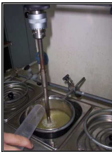
Fig. AII-3.1 Adición de sosa al aceite
