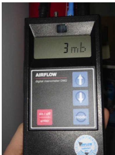
Imagen 7 Medidor de presión diferencial
