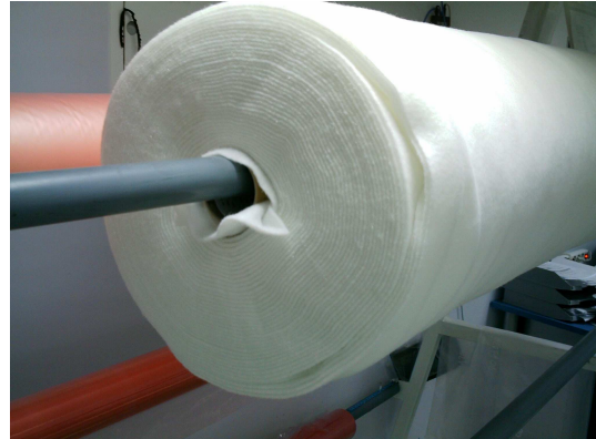
Imagen 23 Tejido aireador de superficie (Airweaver)
