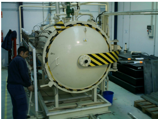
Imágenes 75 y 76 Operario cerrando la puerta del autoclave para posteriormente dar comienzo al ciclo de curado mediante el ordenador de control del armario del mismo
