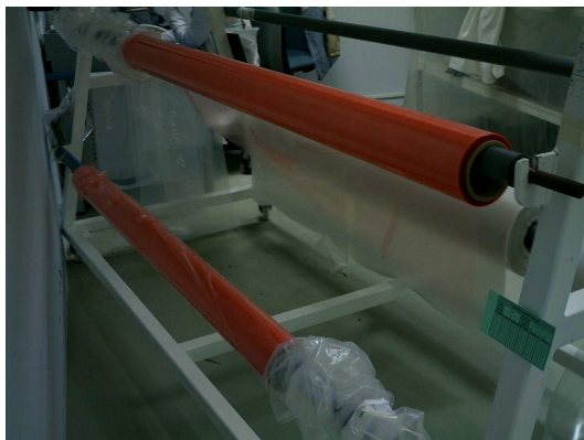
Imagen 24 Película separadora perforada (A4000)
