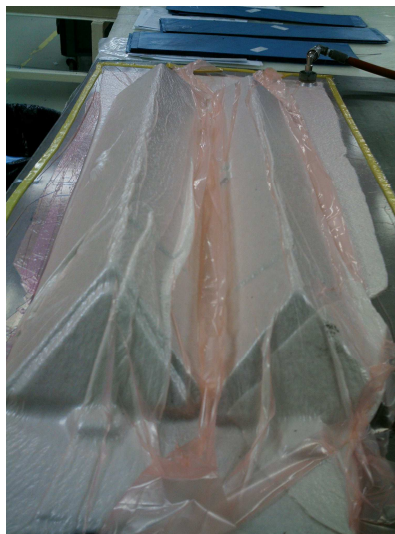
Imagen 32 Bolsa de compactación mientras se aplica vacío para extraer el aire (3)
