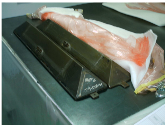
Imagen 26 Útiles listos para apilar sobre ellos con bolsa de compactación preparada
