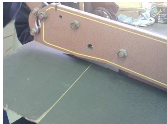
Imagen 86 Recanteo con cizalla de un panel de fibra de carbono
