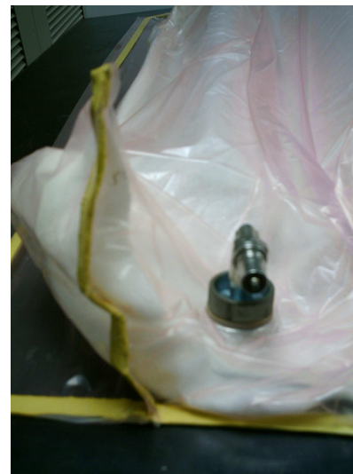
Imagen 33 Vista cercana de una toma de vacío (debe situarse sobre el tejido aireador)
