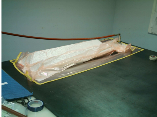
Imagen 30 Bolsa de compactación mientras se aplica vacío para extraer el aire (1)
