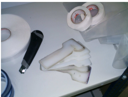
Imagen 20 Cutter y paletas de Nylon para peinado de telas
