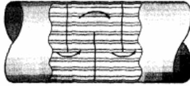
Figura: Placas deflectoras de tipo segmentado sencillo
