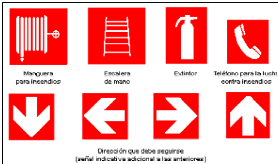
Figura 2.4. Señales relativas a los equipos de lucha contra incendios
