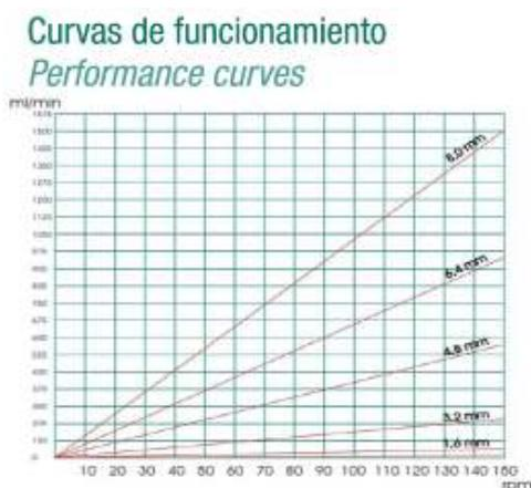
**Figura 23. Curva de funcionamiento bomba peristáltica.**
