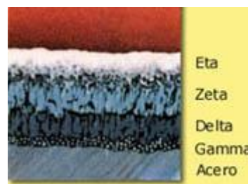
Figura 5. Capas del recubrimiento galvanizado
