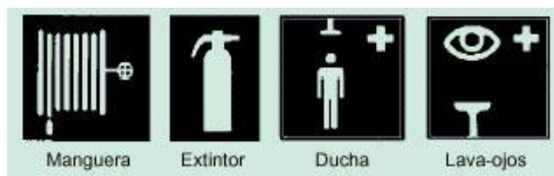
Figura 16. Señalización de los elementos de actuación
