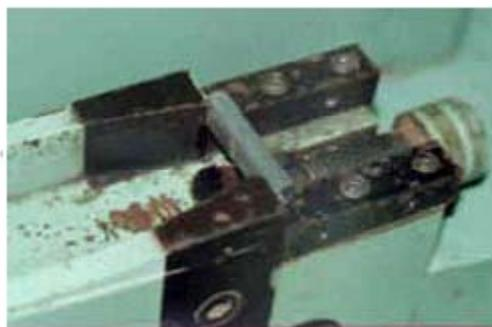
*Probeta CHARPY lista para ensayar*
