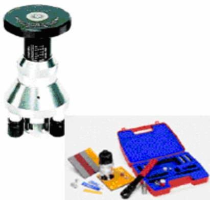
*Medidor de pruebas para adherencia por arranque*
