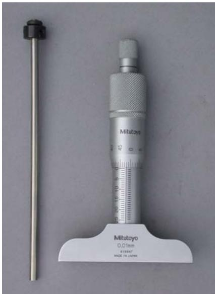
El perfil superficial será determinado por medio de un micrómetro sobre la superficie. La frecuencia mínima de la prueba será dos veces por turno. Cualquier área que no alcanza un perfil angular de 50-100 micras será de nuevo “chorreada” con el sistema de abrasión y reexaminada.
