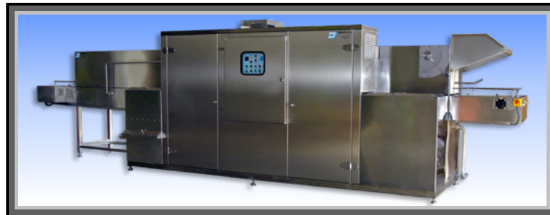
Figura 28. Túnel de tratamiento a la salida del saladero.
