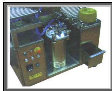
Detalle de bandeja de recogida y calderín
