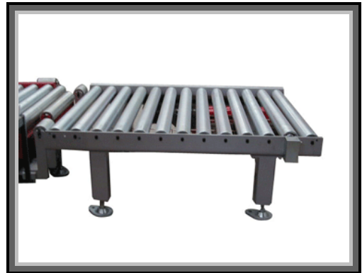
Figura 41. Tramo de rodillos de gravedad.
