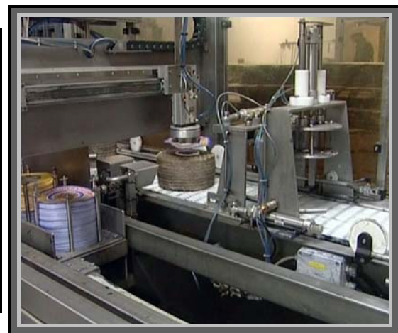
Detalle de colocación y centrado de etiquetas
