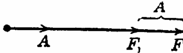
Fig.30. Diagrama vectorial demostrativo del efecto de la reacción del inducido cuando la corriente está en avance de 90° respecto a la tensión.
