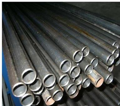
**Figura 3. Tubería acero galvanizado**
