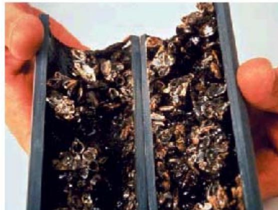
Figura 2.15.- Corte trasversal de una tubería taponada por mejillones cebra
