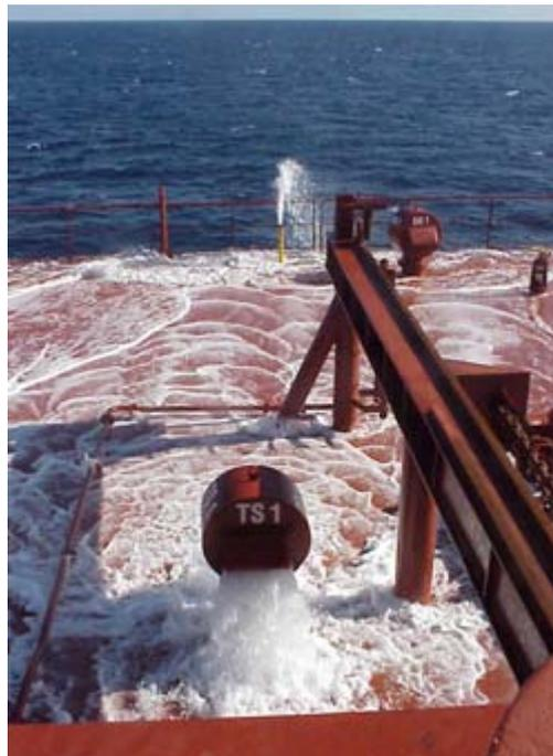
Figura 3.7.- Momento del rebose del agua de lastre en un proceso de flujo continuo
