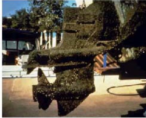
Figura 2.14.- Motor colonizado por el mejillón cebra
