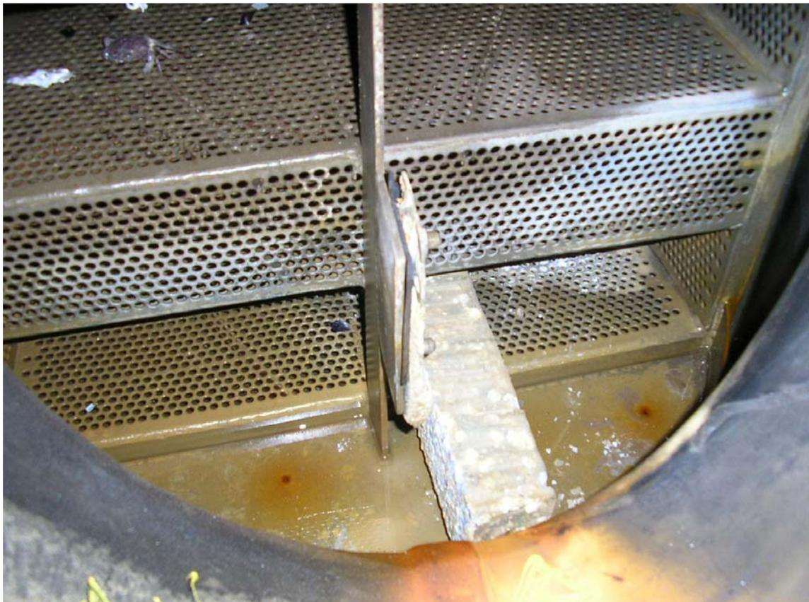
Figura 4.5.- Filtro para disminuir frenos al tratamiento del lastre, como “obstáculos crustáceos” en este caso
