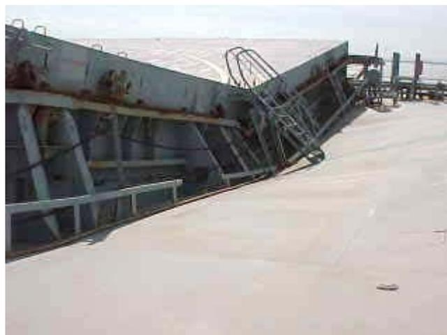
Figura 3.5.- Resultado del daño provocado por el vacío en una bodega de lastre
