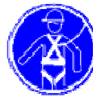
Protección individual obligatoria contra caídas
