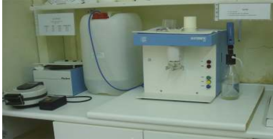
Dispositivo de medición del glúten de la harina
