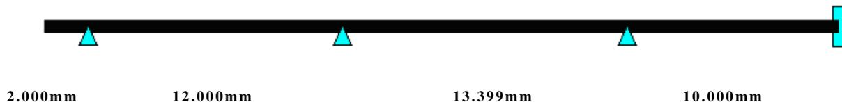
Una vez confirmada la posición de los apoyos, comprobamos los resultados con el software, en el que observamos que tenemos unos valores demasiado altos de flecha, muy por encima de nuestros objetivos en el que tenemos establecido no sobrepasar de 1mm de flecha, sobre todo en el span 1 y span 2 zona más próxima a la hélice debido al peso que debe soportar de la misma.
