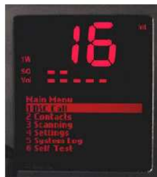
Pantalla superior para VHF. Pantalla inferior destinada a DSC y otras funciones
