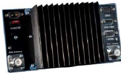
La trasera incorpora un conector de alimentación de nuevo diseño más robusto y seguro.
