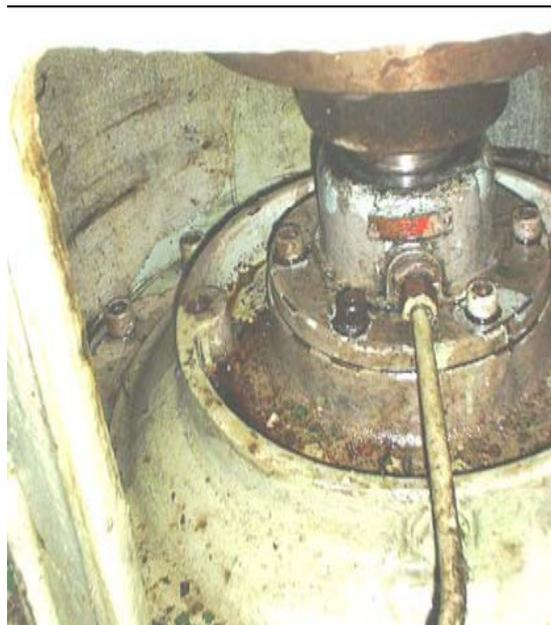
Las bridas de vapor defectuosas se estropean a menudo a bordo de los buques y pasan inadvertidas durante períodos largos.
