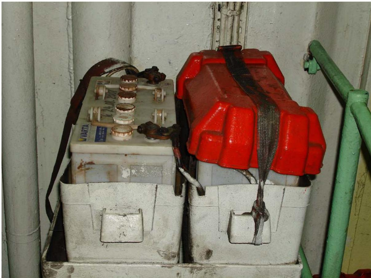
Aparecen aquí las 2 baterías del propulsor principal ubicadas en la entrada de la Sala de Control. Como se ve en la fotografía, queda demostrado que las baterías se encuentran colocadas sólo en una altura, tal y como se exige en el punto 4 de la Check List.
