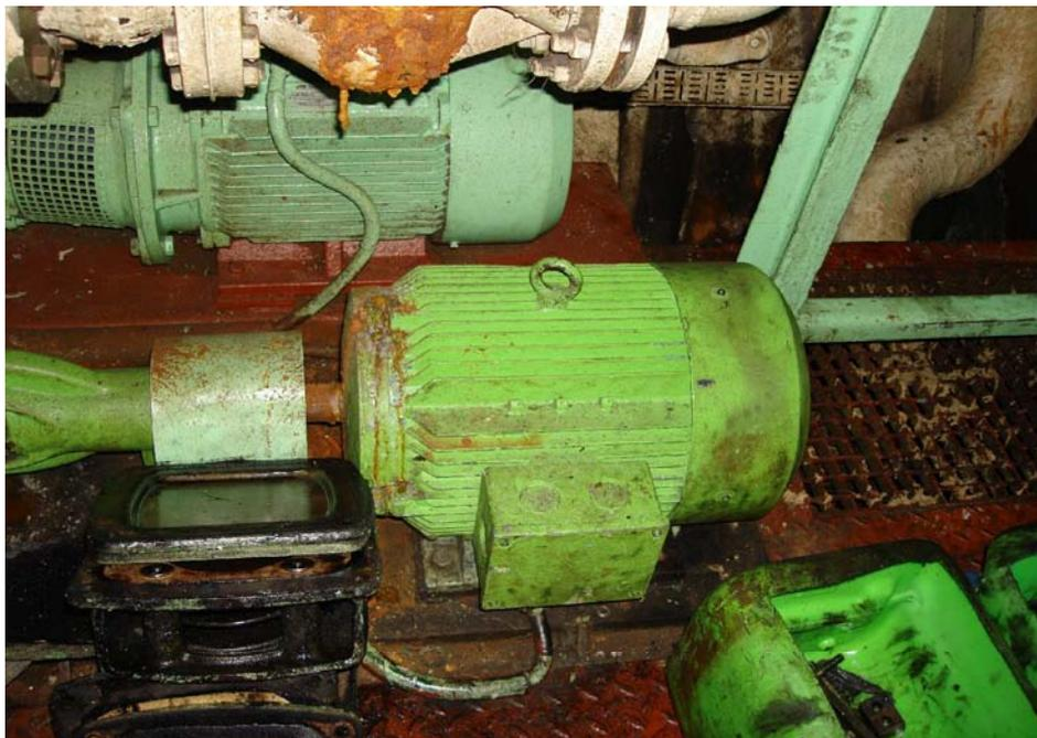
Este es el motor eléctrico de una Bomba de Refrigeración de Agua de Mar, sobre él hicimos el informe de inspección de las comprobaciones eléctricas que se piden en la Check List a la que asociamos la imagen.
