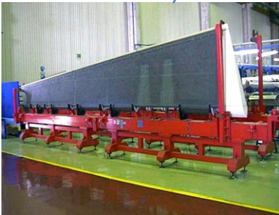
Cajones laterales del estabilizador horizontal
