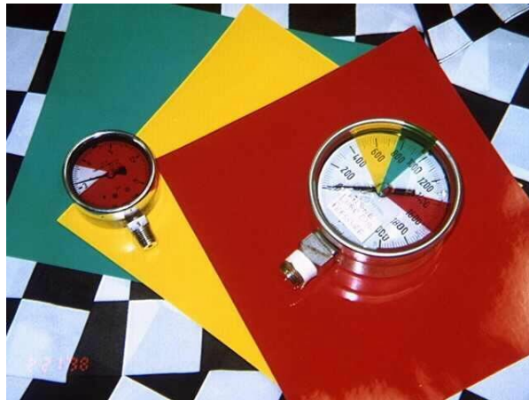
Figura 4.12. Manómetros de Control Visual
