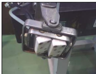
IMAGEN 113. Detalle de Cabezal de Inspección
