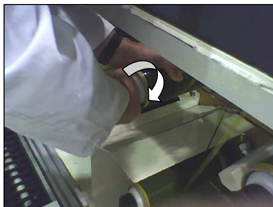
IMAGEN 262. Modo de agarrar la bobina a la máquina
