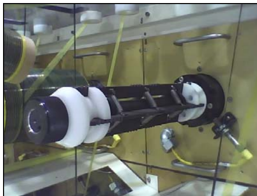
IMAGEN 261. Sistema de agarre de bobina que necesita ser cambiado
