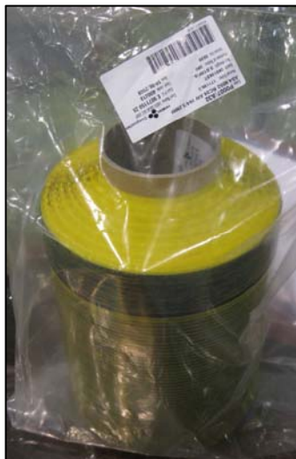
IMAGEN 48. Bobina de Material Preimpregnado
