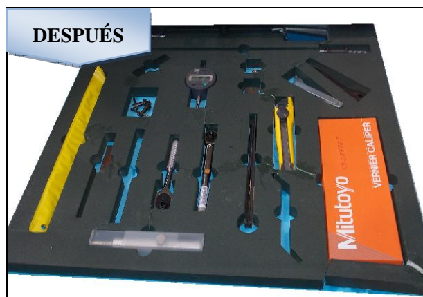
IMAGEN 157. Esponja para la colocación de Herramientas en Cajones
