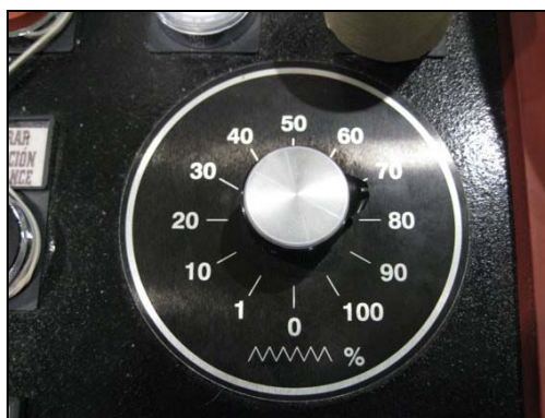
IMAGEN 300. Detalle del Potenciómetro de la Fiber Placement 1
