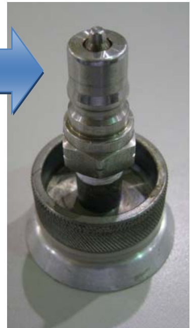
IMAGEN 64. Detalle de una Toma de Vacío
