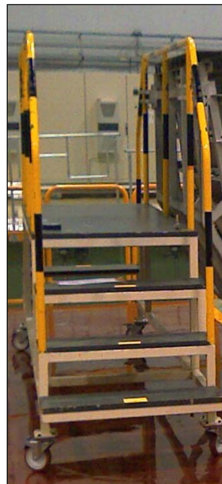
IMAGEN 162. Grada de Montaje A340
