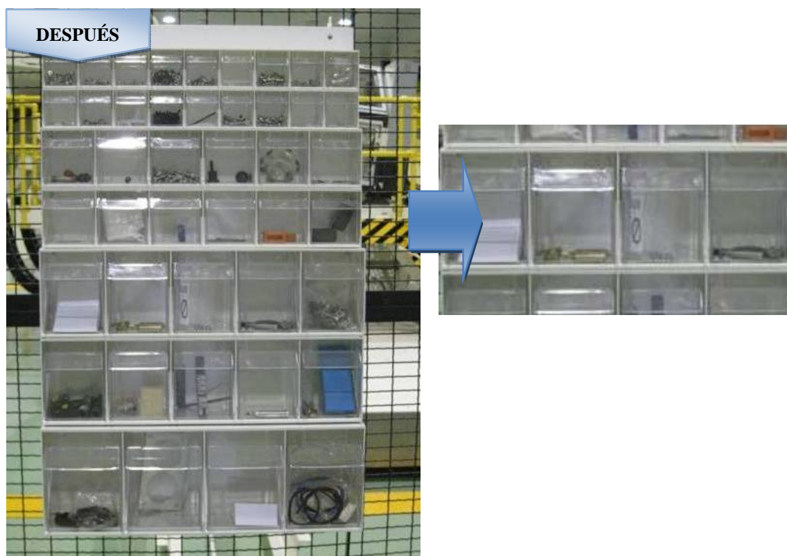
IMAGEN 167. Rack de Repuestos para Reparaciones de Fiber Placement
