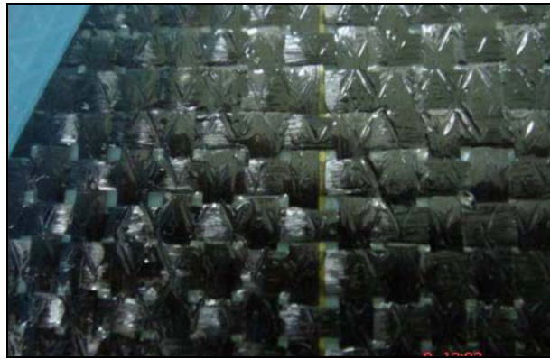
IMAGEN 39. Detalle de Tejido de Fibra de Carbono
