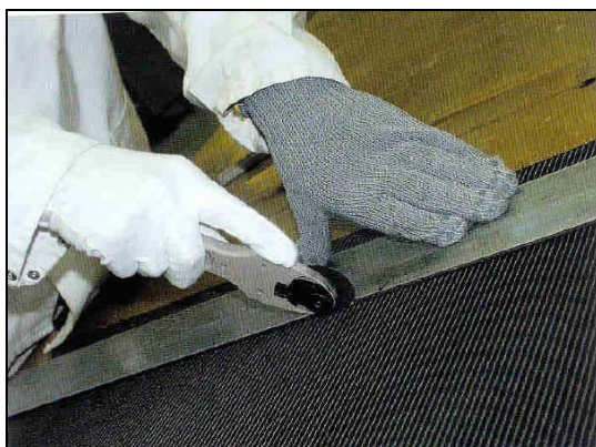
IMAGEN 273. Operario Cortando Material Preimpregnado
