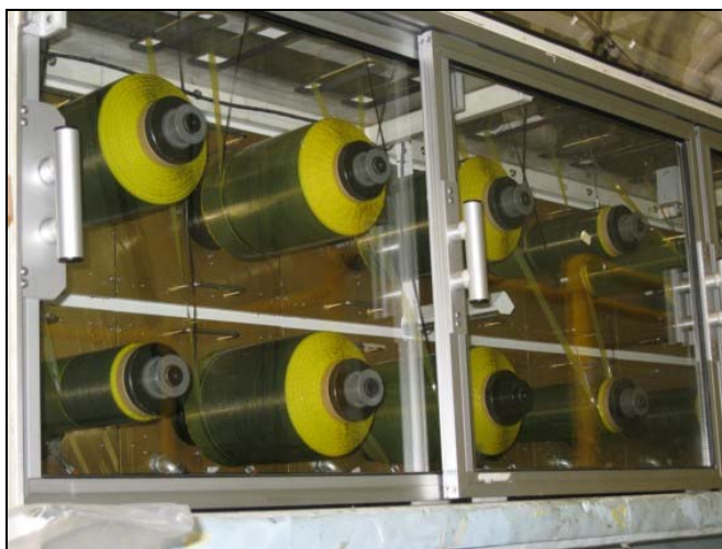
IMAGEN 250. Detalle de ventanas para visualización de bobinas del armario
