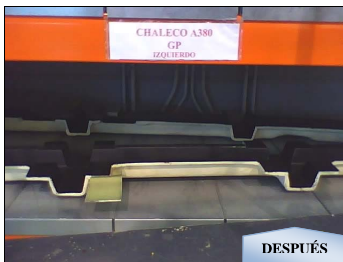
IMAGEN 175. Carcasas de taladrado colocadas en Estanterías con Referencia al Programa que Pertenece y sin son derecho o izquierdo
