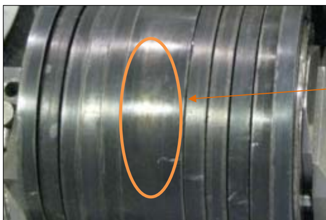
IMAGEN 305. Detalle del desgaste de la superficie del Compactador
