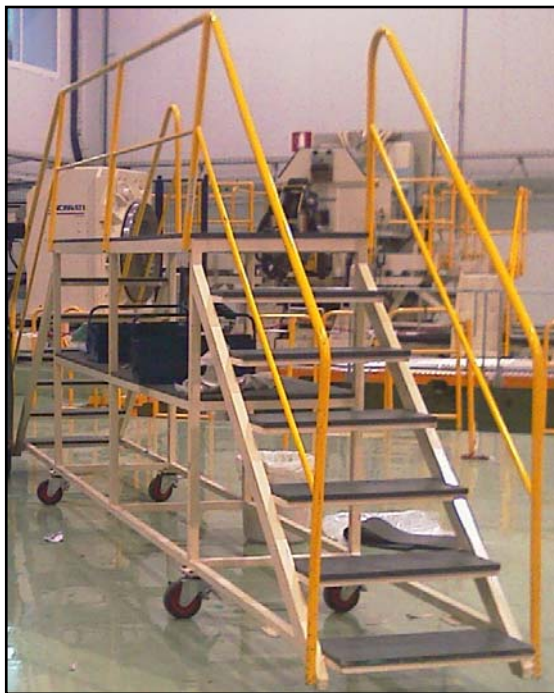
IMAGEN 161. Grada de Montaje A380
