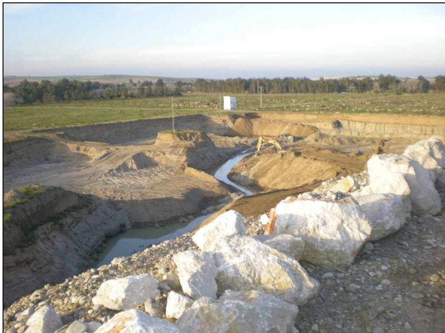
**Fig. 5.4.** Gravera Los Algarrobos, vista al norte. Zona de explotación actual; afloramiento de agua subterránea debida a la proximidad del río.
