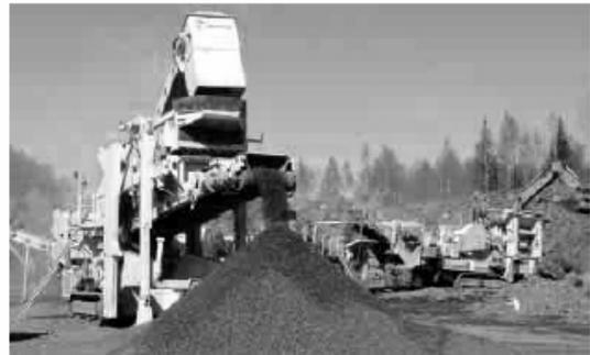
*Proceso de trituración y cribado en tres etapas con los modelos Lokotrack LT10, LT300GP y LT300GPB.*
