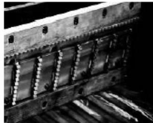
Regleta dentada en el empujador para sujetar el material
