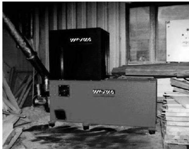
Tritradora de la serie WL 4 S, conectada a una instalación aspiradora
