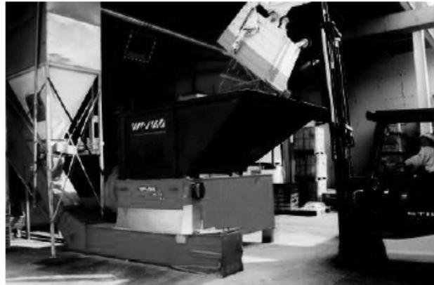
Trituradora de la serie WL 15, entrada de material mediante una carretilla de horquilla elevadora con dispositivo de volcado
