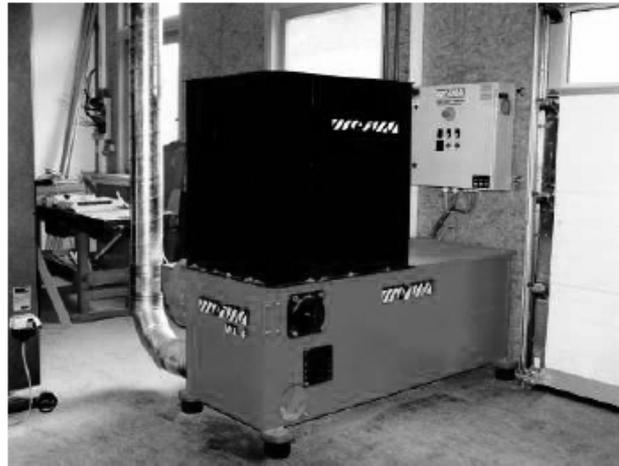
Tritradora de la serie WL 4, conectada a una instalación aspiradora
