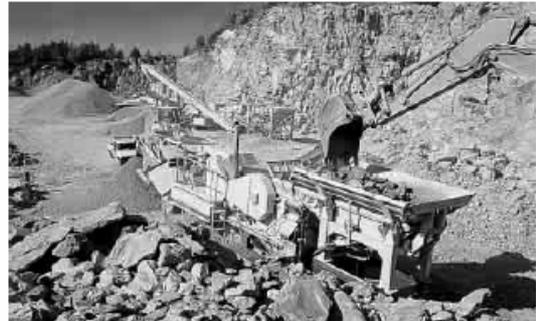
*La planta móvil de trituración con mandíbulas Lokotrack LT10SS produce 2 productos en una sola fase.*
