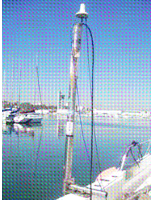
Fotografía 7: Instalación de la antena del GPS en la borda de la embarcación.
