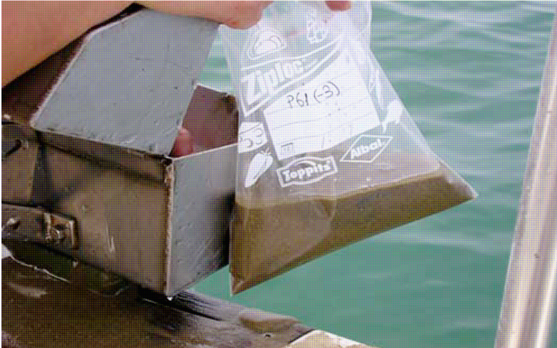
Fotografía 9: Toma de muestras de la zona sumergida con la cuchara Van Veen. Posiciones de las Muestras:
