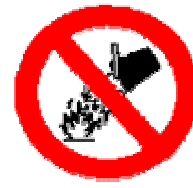
Prohibido apagar con agua
