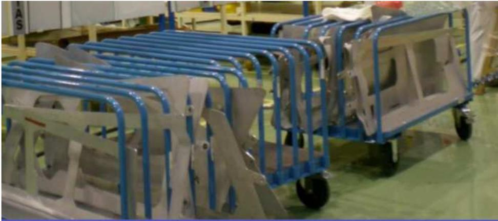
Fig. 129. Carros para plantillas de posicionamiento
