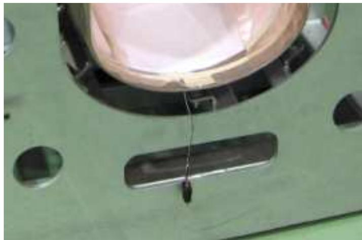
*Fig. 103. Detalle de termopar en PEAU de FSF*
