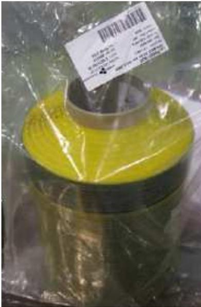
Fig. 76. Bobina de preimpregnado.
