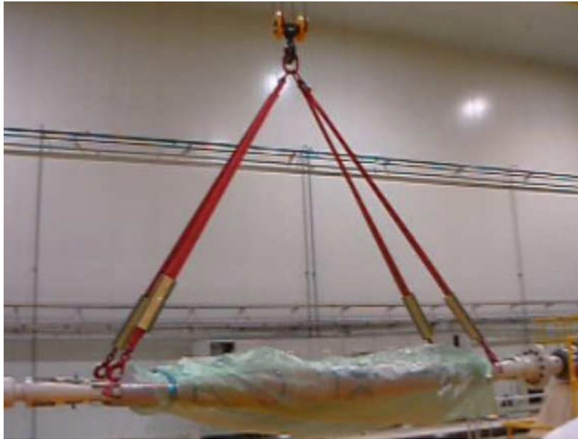
*Fig. 92. Útil 1 en posición eslingado en posición de carga.*
