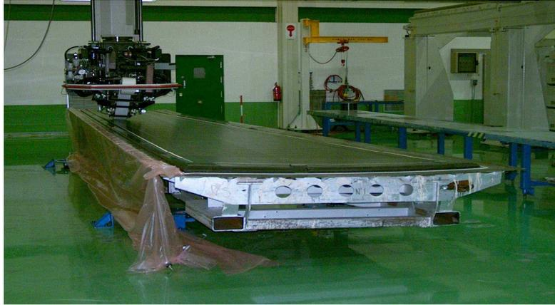
Fig.39. Máquina A.T.L.
