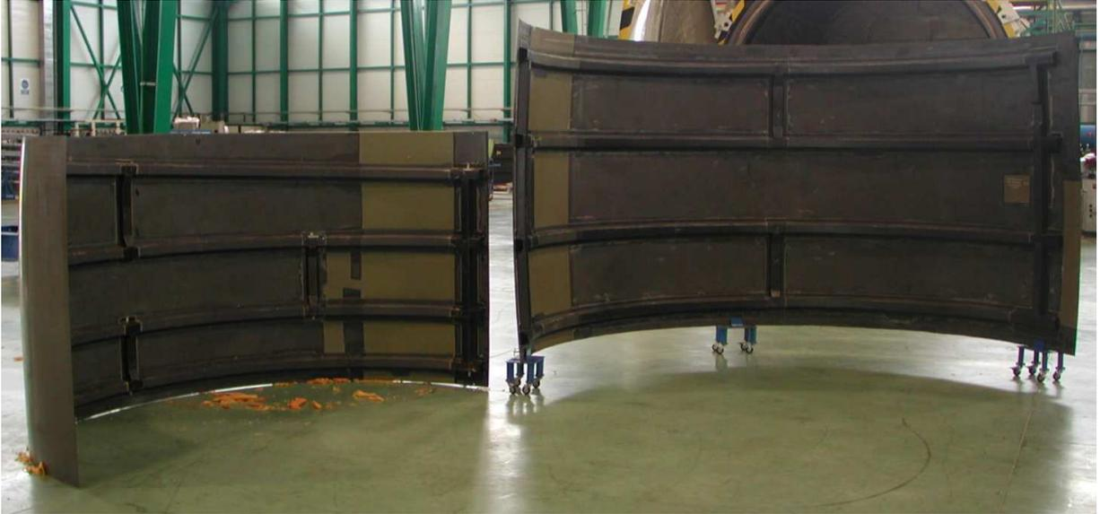
Fig.81. Capós terminados para A340 y A380.
