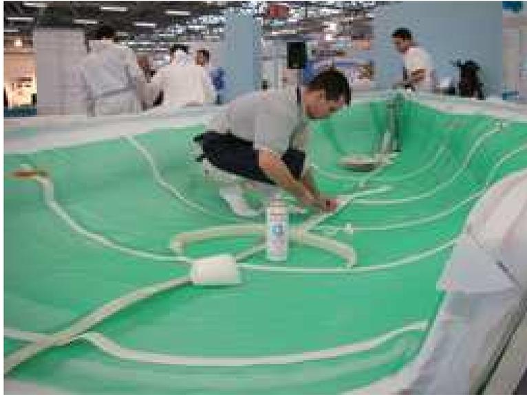
*Fig. 50. Preparación del sistema de Infusión.*
