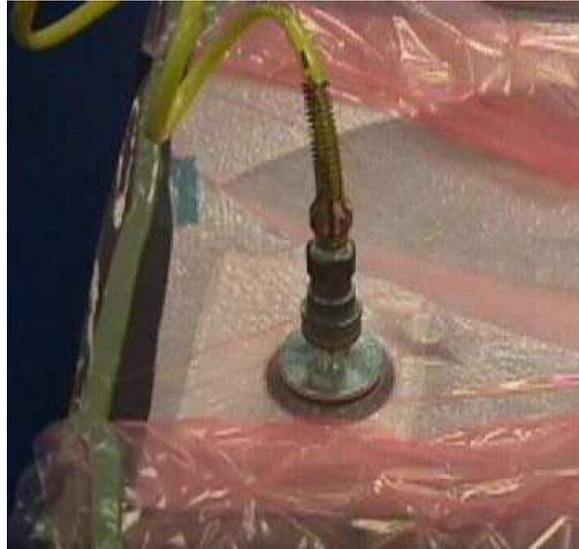
Fig. 101. Toma de vacío
