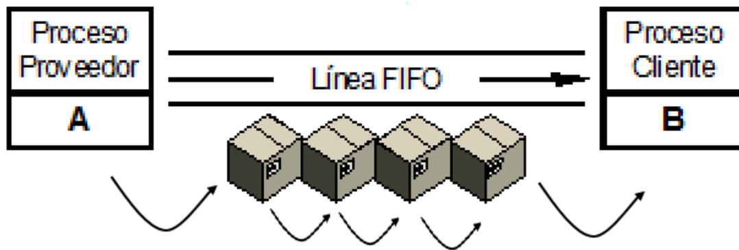
*Fig. 146. Sistema FIFO*
