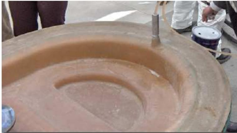
Fig.48. Contramolde e inyección de resina.
