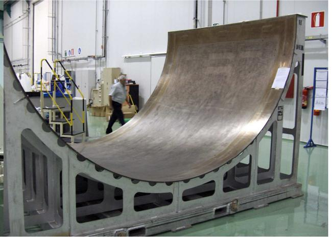
Fig. 44. Útil PEAU para capó A380
