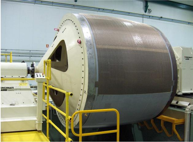
Fig. 43. Útil PEFP para capó A380
