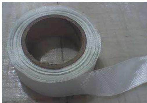
*Fig. 58. Cinta de fibra de vidrio aireadora.*
