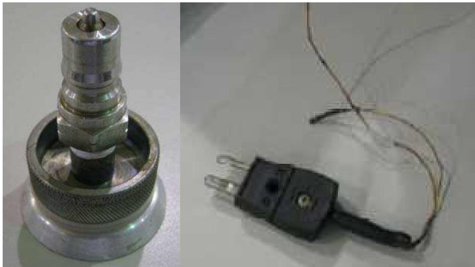
*Fig. 63. A la izquierda una toma de vacío, a la derecha un termopar.*
