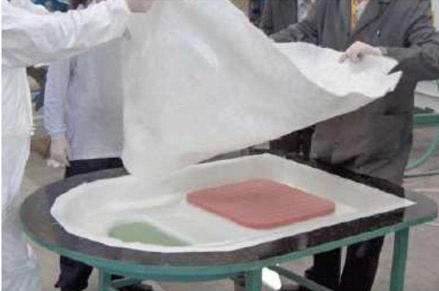
Fig.47. Colocación fibra seca.
