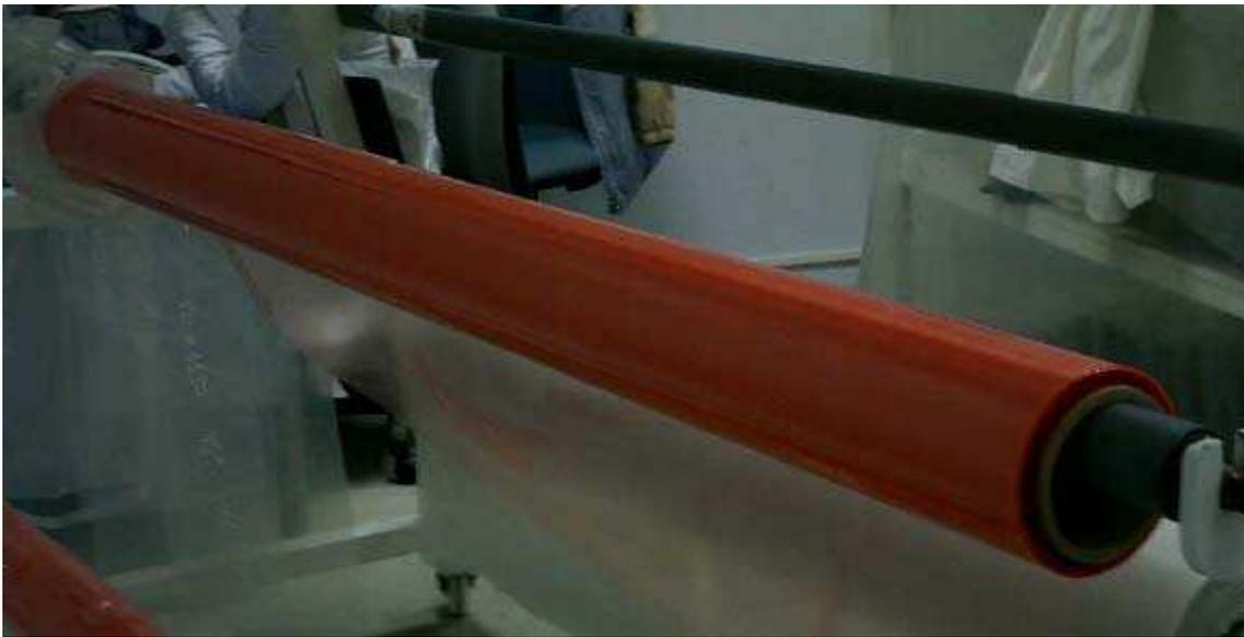
*Fig. 55. Ejemplo de película separadora.*
