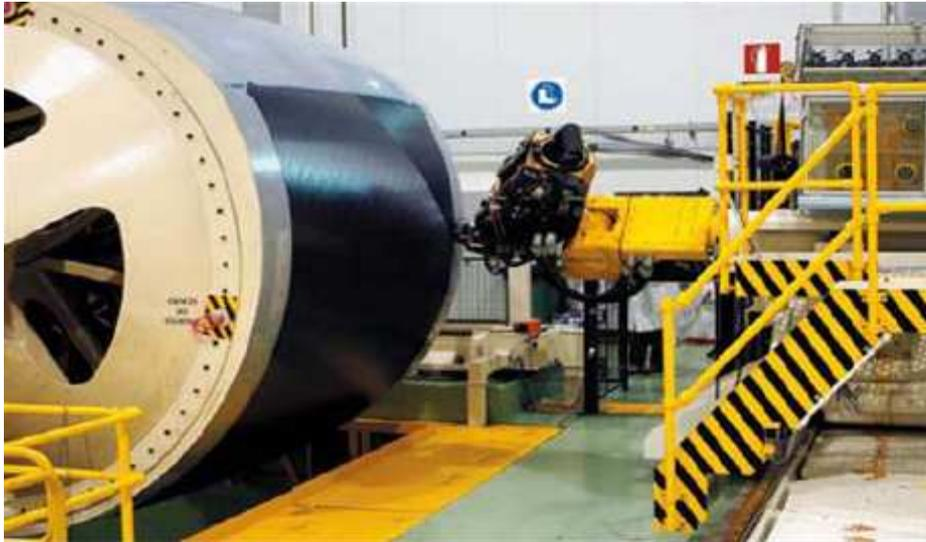
*Fig. 69. Ejemplo de máquina F.P. laminando una piel.*
