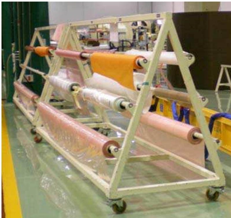
*Fig. 125. Portarrollos de material auxiliar*
